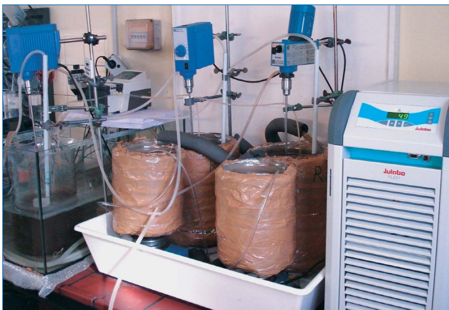
■ Рис 2. Экспериментальная установка для исследований при температуре от 3 до 20°C
